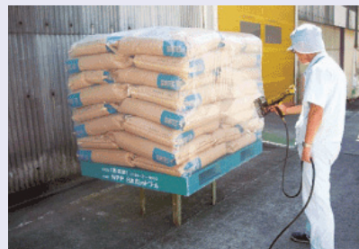
パレット積みした製品の荷崩れ防止
